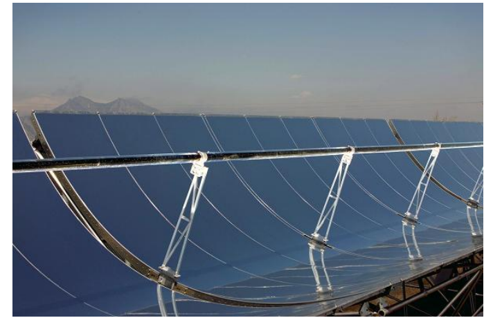
5.att. Cilindriski paraboliskais saules enerģijas kolektors. Spoguļi, kas koncentrē enerģiju uz uztvērēj- cauruli. http://www.seia.org/policy/solar-technology/concentrating-solar-power .
