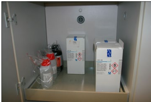
Pareiza korozīvu vielu (skābju un bāzu) uzglabāšana
