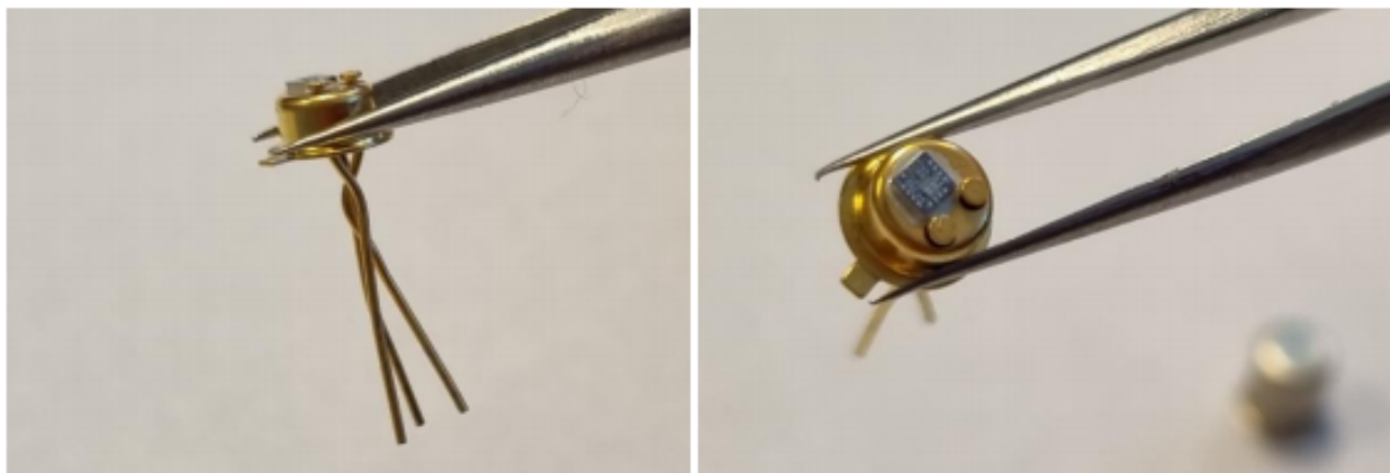
1.attēls. Izgatavotā mikrotriodes struktūra ar noņemto vāciņu.
