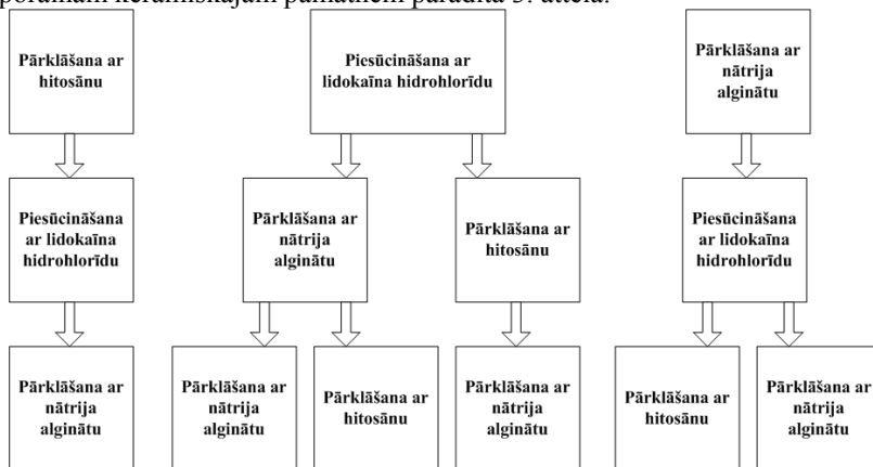
3.att. Lidokaīna piegādes sistēmu izveides shēma uz porainām keramiskām pamatnēm
