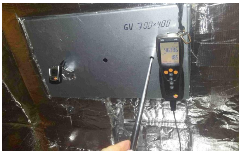
2.1. att. Eksperimentālas iekārtas Dzesētāja izmešanas gaisa parametru mērīšana
