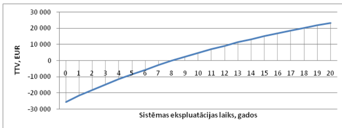
3.3. att. Atmaksāšanas grafiks 7/12 °C temperatūru režīmā KKCD salīdzinot ar KCD–DT dzesēšanas sistēmu
