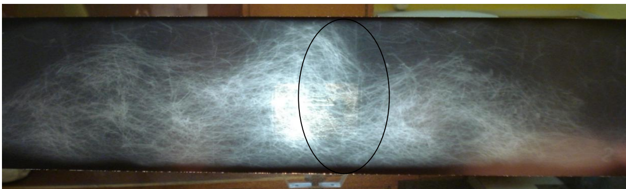
1.13.att. Fibrobetona K2 rentgenuzņēmums (caurskatīts no sāna)
