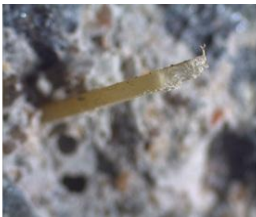
1.1.att. No betona izrautā sintētiskā polimēra šķiedra 90° leņķī (zem mikroskopa)
