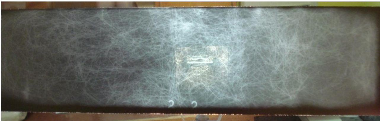
1.12. att. Fibrobetona K2 rentgenuzņēmums (caurskatīts no augšas)
