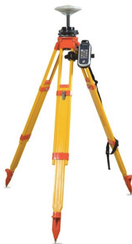
3.2. att. Aprīkojums precīzai GNSS instrumenta uzstādīšanai
