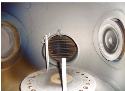
4.1.att. Modernizētas iekārtas NNV-6, 6-II uzputināšanas kamera
