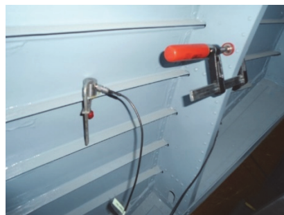
5.2. att. AE sensoru izvietojuma shēma helikoptera fizelāžā.
