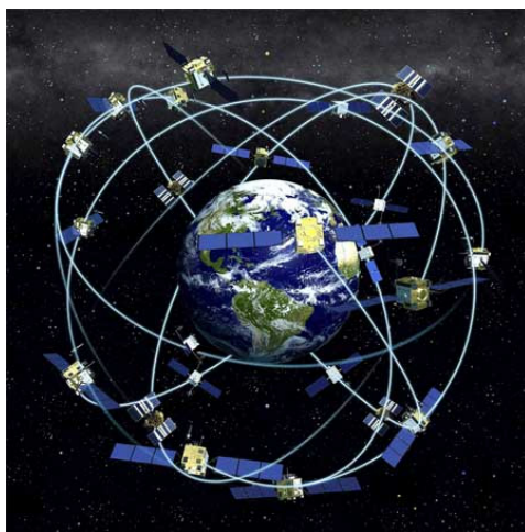
1.1. att. GPS kosmiskā segmenta 24 satelītu zvaigznājs [30]
